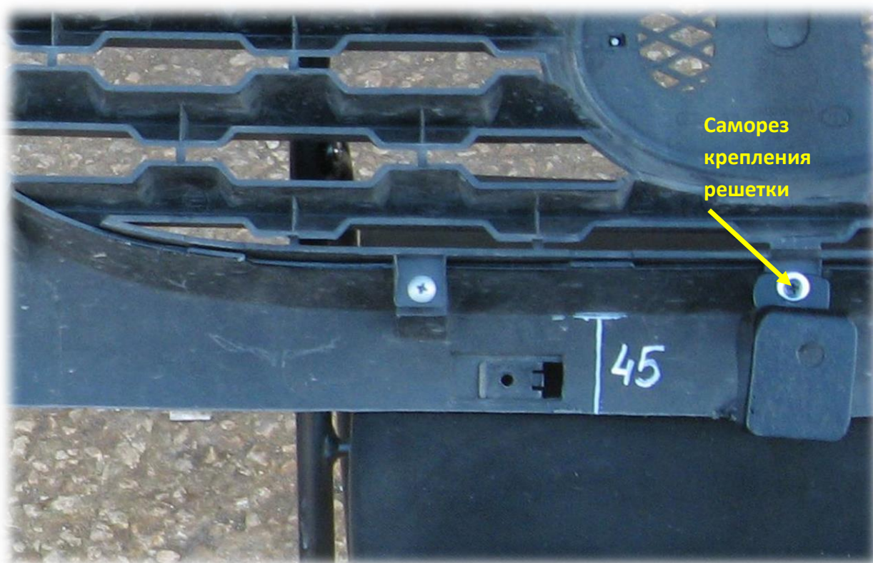
Место крепления держателя на кузове:
