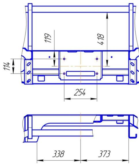
Рис.4 Габаритный чертёж установки лебедки
