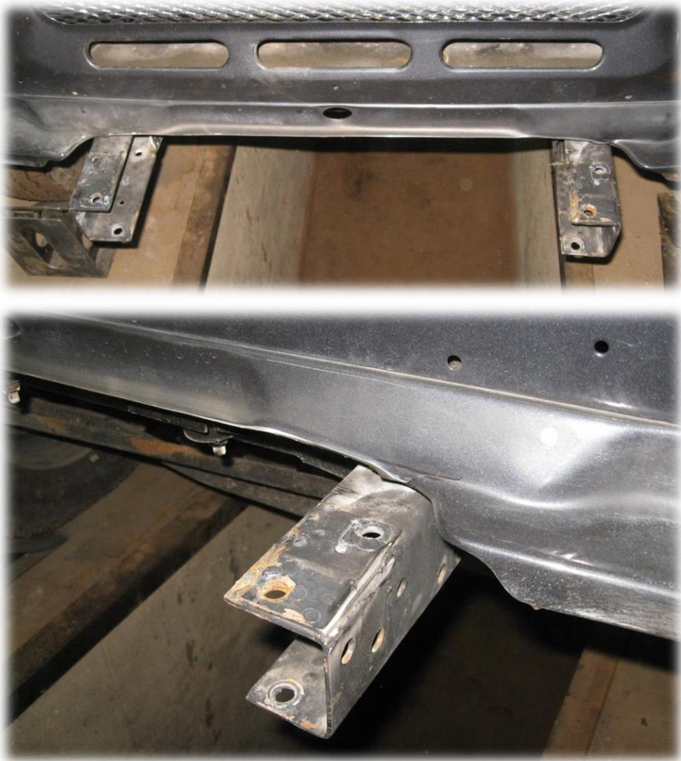
3. Установить бампер на раму и совместить верхние крепежные отверстия на раме и бампере. Установить болты M12x40 с шайбами и наживить со стороны лонжеронов гайки M12.
