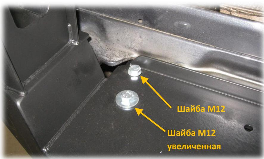
4. Установить Болты M12x40 в боковые и нижние отверстия кронштейнов бампера и наживить гайки M12 со стороны лонжеронов.
