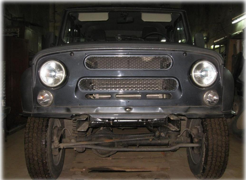
2. Срезать нижнюю горизонтальную часть передней панели кузова и выступающие части накладных пластин для крепления тяговых крюков. Линии реза показаны на фото.
