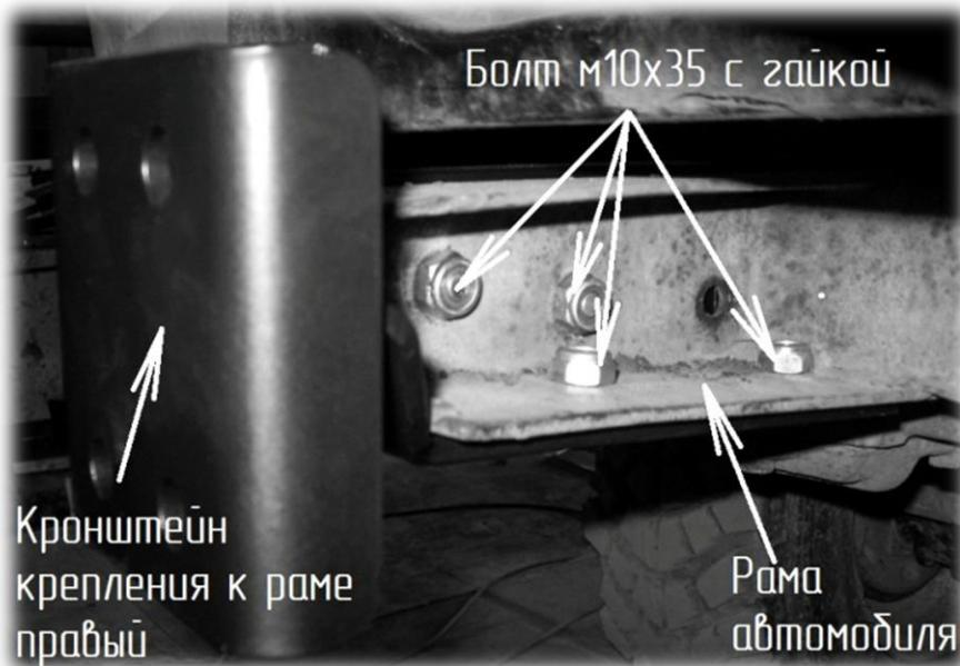
4. Установить левый кронштейн и закрепить прилагаемым крепежом с использованием закладных.
