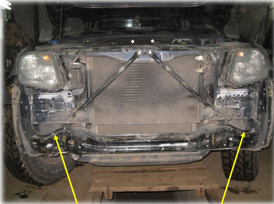
Демонтировать штатный бампер
